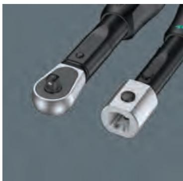
Динамометрические ключи Click-Torque – это трещотки с реверсом (привод  $\frac{1}{4}$ " ,  $\frac{3}{8}$ " ,  $\frac{1}{2}$ " и  $\frac{3}{4}$ " ) или с посадочным гнездом для сменных инструментов (9×12 мм, 14×18 мм) с моментом силы от 2,5 до 1000 Н·м.
